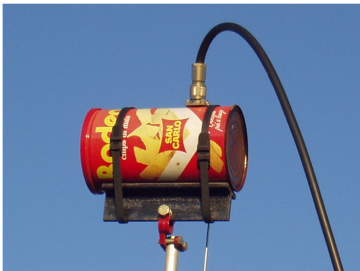
La 'cantenna' per il wireless fatta con un barattolo per patatine.
